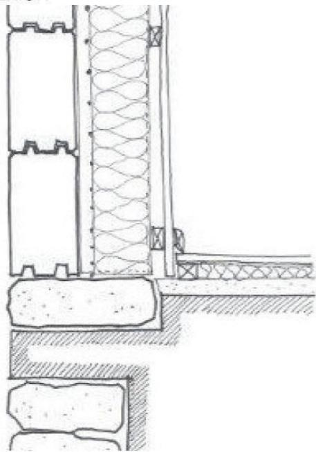
**Detaliu perete - secțiune verticală****EXTERIOR**
